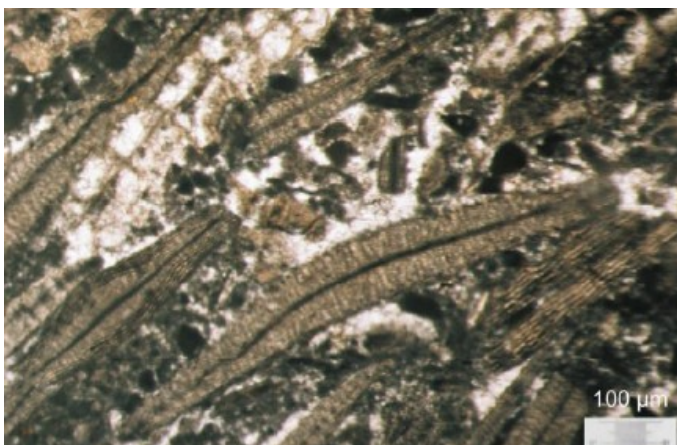
1. ábra: A Mátyás-hegyi barlang bejáratánál gyűjtött nummulinás szépvölgyi mészkő mikroszkópi képe
